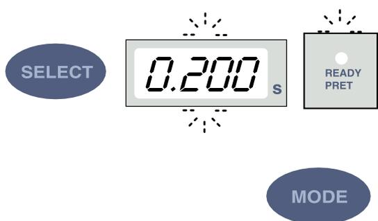
Appuyer sur la touche SELECT et la **maintenir enfoncée** jusqu'à ce qu'un signal sonore retentisse (environ 4 secondes) pour passer en mode Programmation. L'écran du temps d'exposition et le voyant lumineux Prêt se mettent à clignoter.
